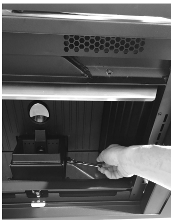
Fig. 31 - Extracción de los pisos
