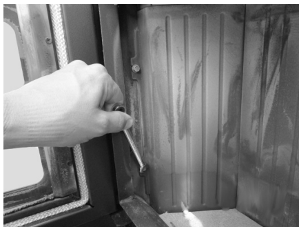
Fig. 32 - Extracción de los tornillos
