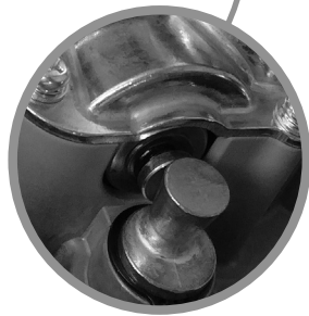
Posizione del motor sbloccato : Il caperzolo deve essere in posizione permuto
