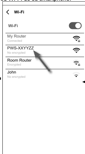
(d) Seleccione el nombre de la red Wi-Fi de la estación base (el nombre siempre comienza con PWS-) para conectar su smartphone a la estación base. A continuación, regrese la aplicación WSLink.
