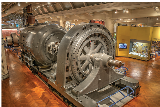
Fotografía de un generador de corriente alterna proveniente de una central hidroeléctrica expuesto en el Museo Henry Ford en Michigan. Se pueden observar el rotor (la parte móvil que gira junto al eje central) y el estátor (la carcasa estática). El movimiento del rotor generaba corriente eléctrica en el estátor que posteriormente se inyectaba en la red eléctrica.
