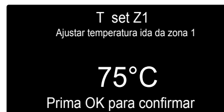
Modificação temperatura água quente aquecimento
