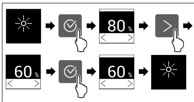
Fig. 69 Representación a modo de ejemplo: Cambiar de 80 % a 60 %.
