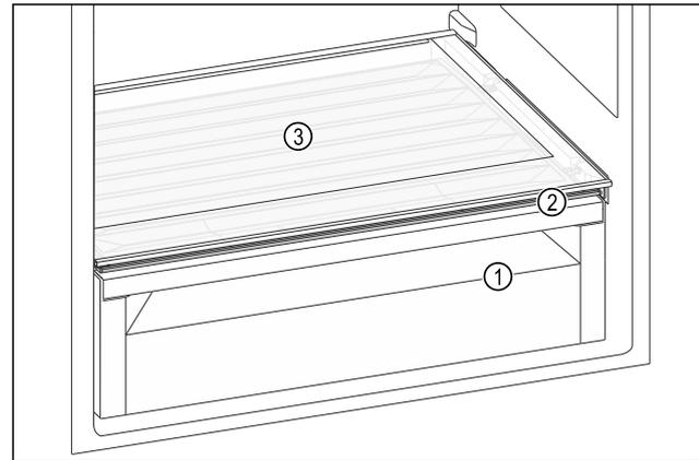
*Fig. 136 Representación a modo de ejemplo de la tapa del compartimento del cajón EasyFresh*
