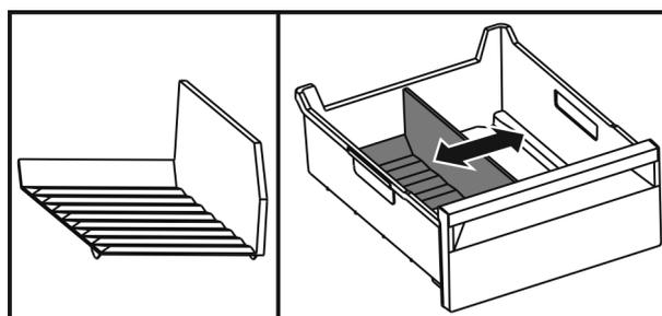
Fig. 146 Representación a modo de ejemplo del separador para congelador
