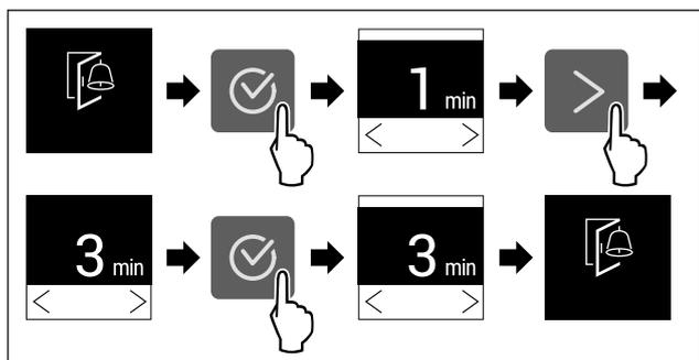
Fig. 71 Representación a modo de ejemplo: Cambiar alarma de puerta de 1 minuto a 3 minutos.
