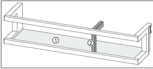
Fig. 102 Representación a modo de ejemplo del estante en la contrapuerta con soporte para botellas
