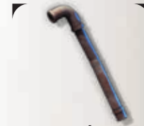
TUBERÍA DE PLOMO
